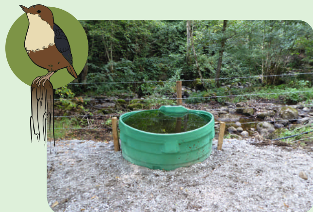
Abreuvoir gravitaire avec flotteur à niveau constant (bac PVC)
