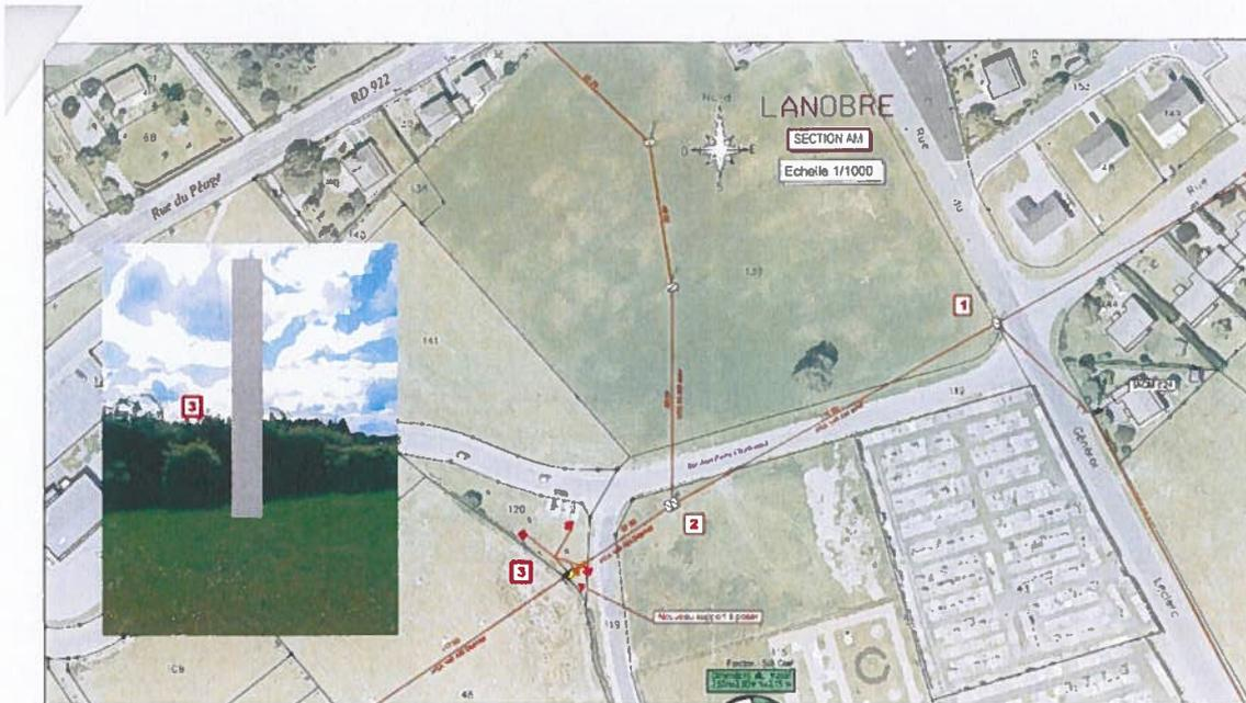
La première convention de servitude à signer concerne l'installation d'un support (emprise au sol de 260 cm\*260cm) au niveau d'une ligne électrique aérienne de 20 000 V. La deuxième concerne l'établissement d'une canalisation électrique souterraine de 20 000 V, ainsi que ses accessoires, dans une bande de 3 m de large sur une longueur d'environ 30 mètres.
